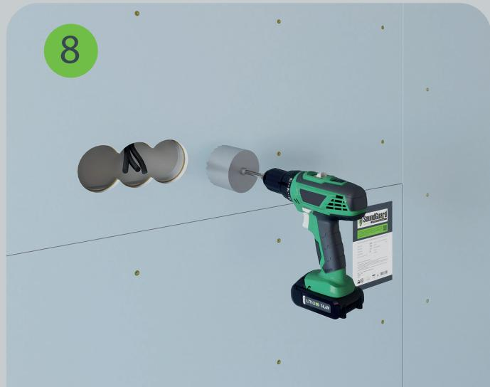
После монтажа звукоизоляционного гипсокартона в нем коронкой просверливается отверстие на месте установки подрозетника SoundGuard ИзоБокс Стандарт. Электрический подрозетник прикручивается к внутренней плоскости короба саморезами.
